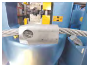
Manșonare cu manșoane din oțel conice (tip Flemish Eye) / Conical steel ferrules swaging (Flemish Eye type)
