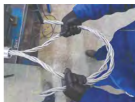
Manșonare cu manșoane din oțel conice (tip Flemish Eye) / Conical steel ferrules swaging (Flemish Eye type)
