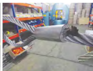
Manșonare cu manșoane din aluminiu conice / Conical aluminum ferrules swaging
