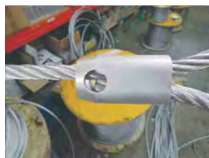
Manșonare cu manșoane din oțel conice (tip Flemish Eye) / Conical steel ferrules swaging (Flemish Eye type)
