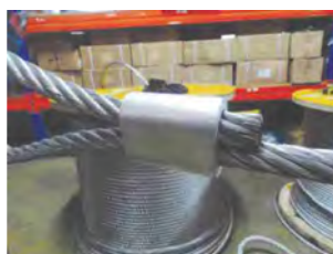
Manșonare cu manșoane din aluminiu conice / Conical aluminum ferrules swaging
