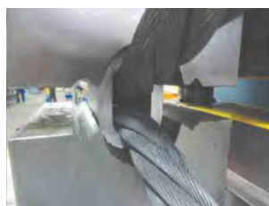
Manșonare cu manșoane din aluminiu conice / Conical aluminum ferrules swaging
