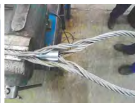
Manșonare cu manșoane din oțel conice (tip Flemish Eye) / Conical steel ferrules swaging (Flemish Eye type)
