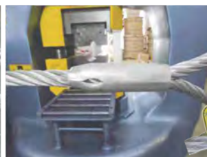
Manșonare cu manșoane din oțel conice (tip Flemish Eye) / Conical steel ferrules swaging (Flemish Eye type)
