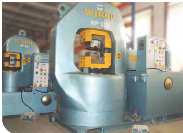
Manșonare cu manșoane din aluminiu cilindrice / Cylindrical aluminum ferrules swaging
